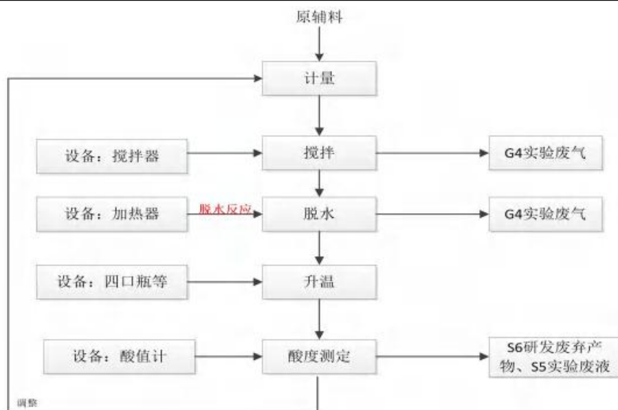
图 2.4-3 研发试验流程及产污环节示意图
